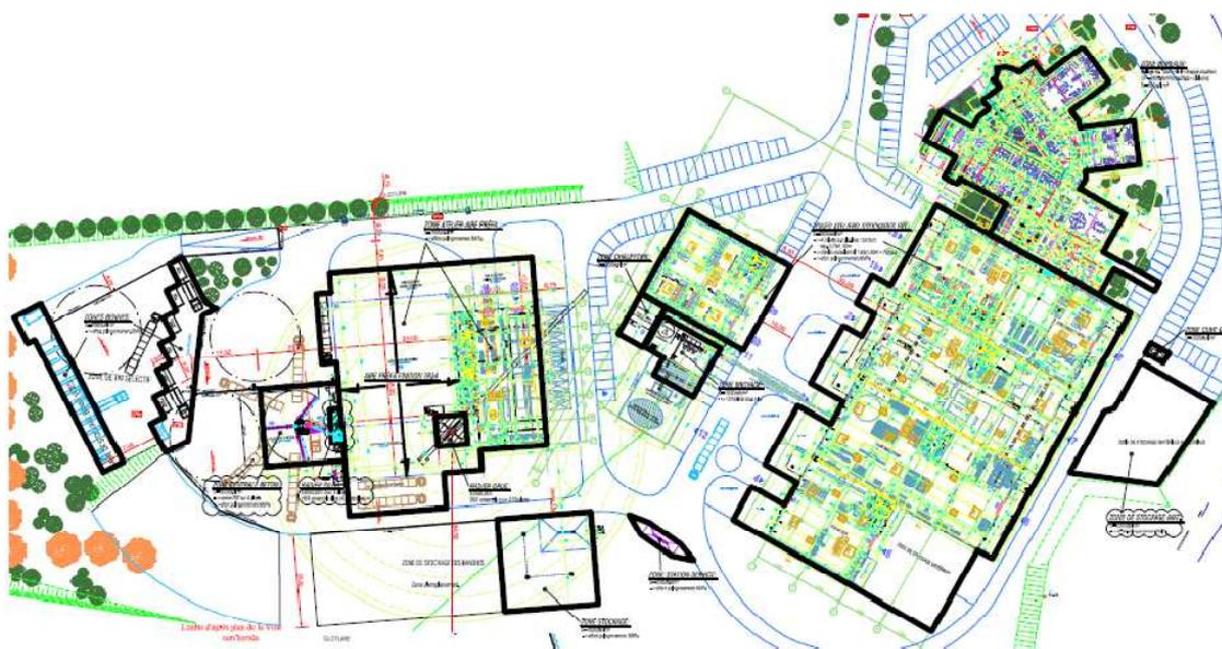
Le stockage des matériaux et les machines représentent une surcharge répartie sur dallage de 20 kPa. Les ateliers comporteront des racks chargés à 4t/pied. Le radier de la centrale à béton sera chargé à 5t/m<sup>2</sup>.
